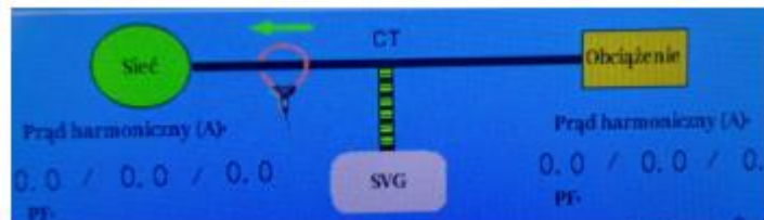
rysunek 17. Ekran główny kompensatora przy przekładnikach od strony zasilania/źródła
